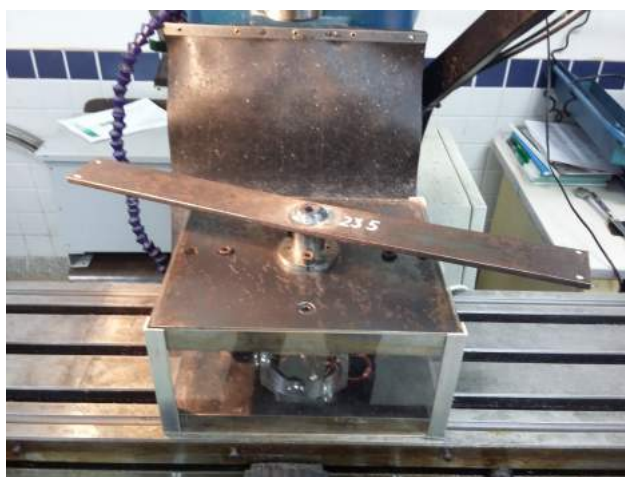
Figura 39 - Ferramenta de calibração do torque montada no dinamômetro.
