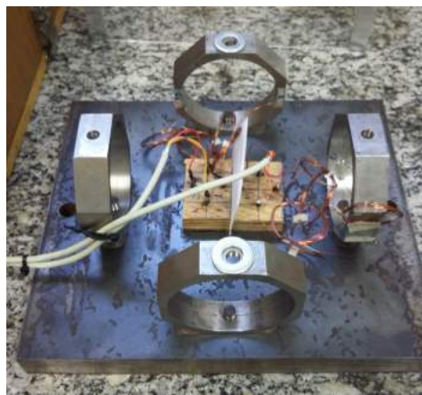
Figura 32 - Mudança no posicionamento dos anéis e inclusão das arruelas.
