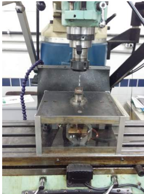
Figura 42 - Dinamômetro fixado na fresadora para início dos testes.
