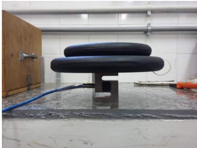
Figura 36 - Medição das anilhas através da célula de carga.
