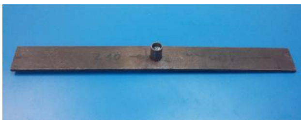
Figura 38 - Ferramenta fabricada para calibração do torque.
